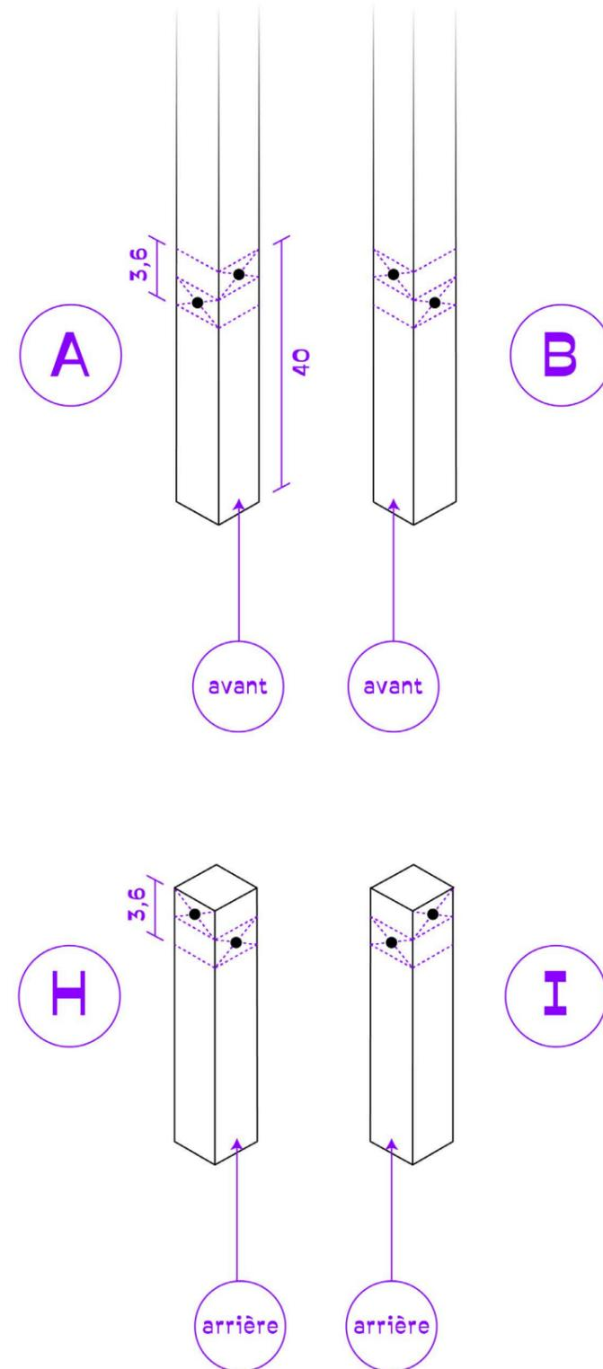
Ces avant-trous permettent de préparer les tasseaux aux grandes visse, pour les tasseaux qui vont servir à relier deux autres éléments (p. 4).
